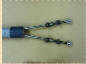
Puntas extendidas con ruedas en estrella adicionales. Las ruedas en estrella (espuelas o "spurs") en acero inoxidable son mejores conductoras que las de acero carbono
